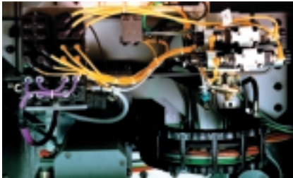
Bild 3. Standardisierte M12-Verbindungstechnik in der E/A-Installation der Prototypmaschine des iwv
