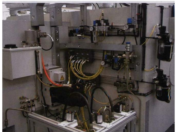
**2 Anschluss einer Pneumatik- und Hydraulikeinheit über Desina**
